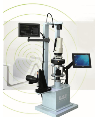
图 2 垂准仪检测系统（带转台）
