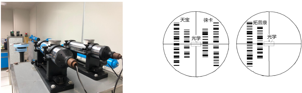
图 2 数字水准仪检定装置（内置标准条码编码影像的专用平行光管）
