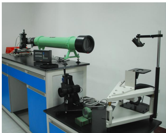
图 3 垂准仪检测系统（含图象采集部分和平行光管部分）
