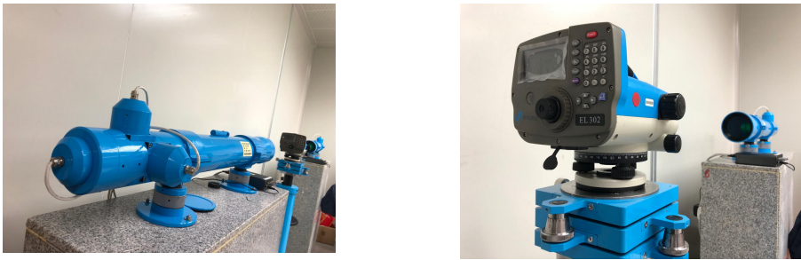
图 1 数字水准仪专用检定装置（内置标准条码编码影像的专用平行光管）
